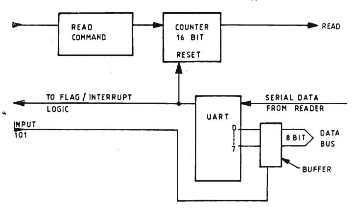
FIGURE 4.14 : BLOCK DIAGRAM OF READER CONTROL
