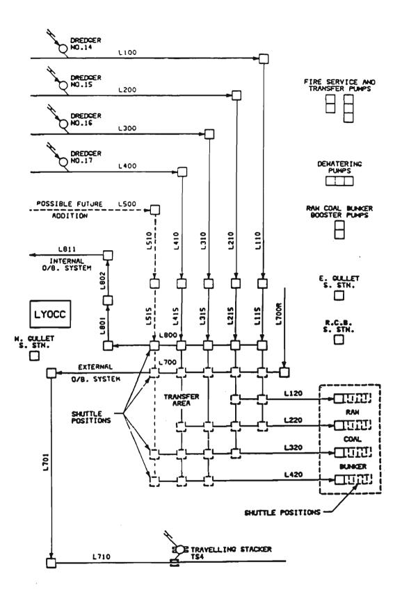
FIGURE 3.1 : LOY YANG OPEN CUT PLANT LAYOUT
