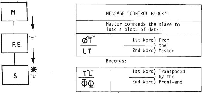
FIGURE 4.24 (d) MASTER TO SLAVE : LOAD IN SLAVE
