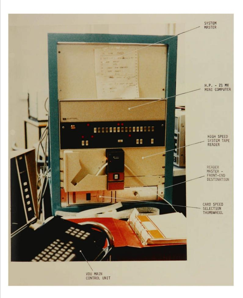
PHOTOGRAPH NO 4 - MASTER COMPUTER -HEWLETT PACKARD 21 MX - FRONT VIEW
