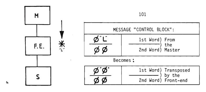
FIGURE 4.24 (b) MASTER TO FRONT-END : LOAD A BLOCK OF DATA
