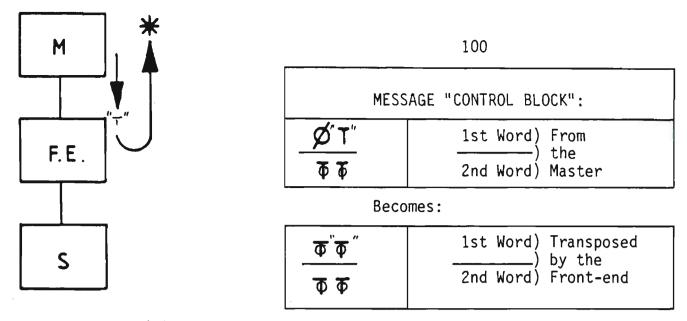
FIGURE 4.24 (a) MASTER TO FRONT-END : SEND A BLOCK OF DATA
