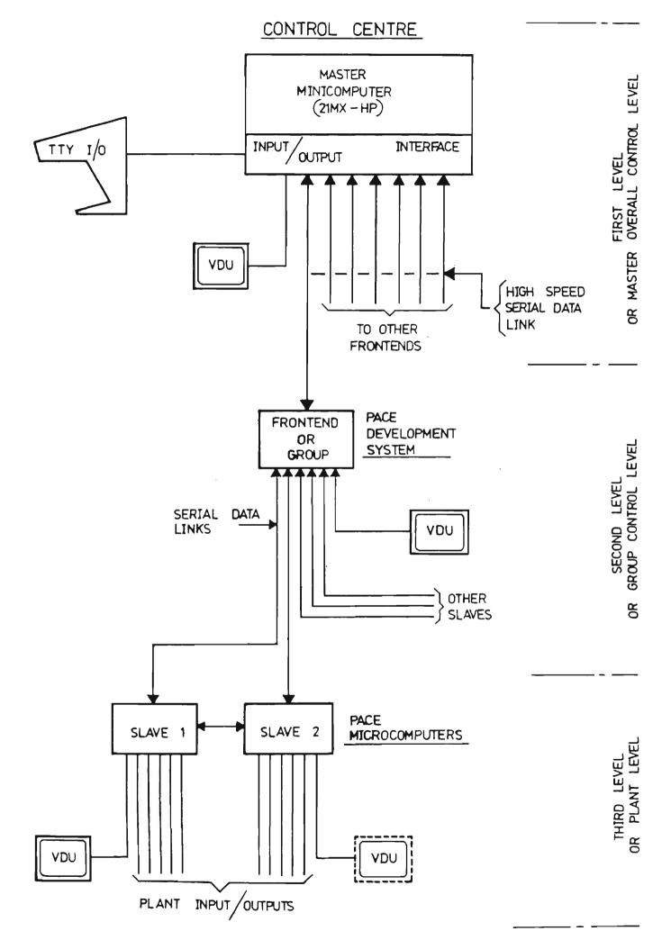
FIGURE 4.2 : SYSTEM CONFIGURATION OF THE EXPERIMENTAL MODEL
