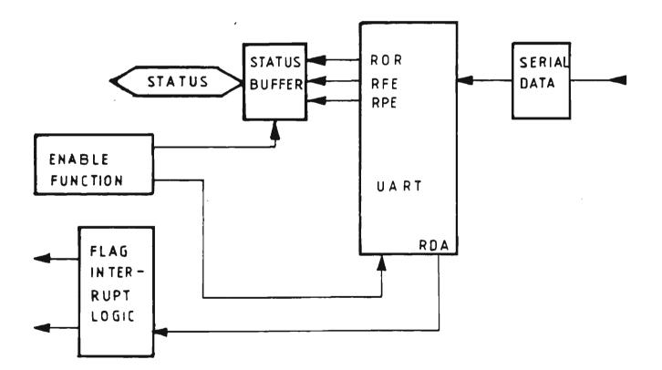
FIGURE 4.17 : ERROR STATUS BLOCK DIAGRAM
