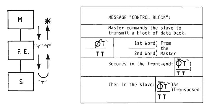
FIGURE 4.24 (e) MASTER TO SLAVE : SEND A BLOCK OF DATA
