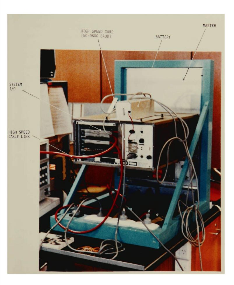
PHOTOGRAPH NO 5 - MASTER COMPUTER -HEWLETT PACKARD 21 MX - REAR VIEW
